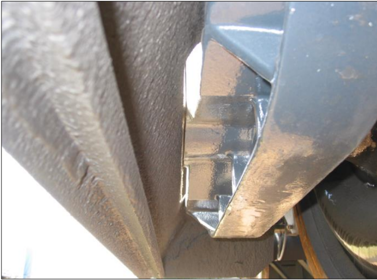
Abb. 28: Schallschürze mit Entdröhnungsmaterial
